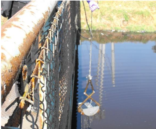
Figura 3. Draga tipo ponar utilizada en el muestreo de sedimento.
