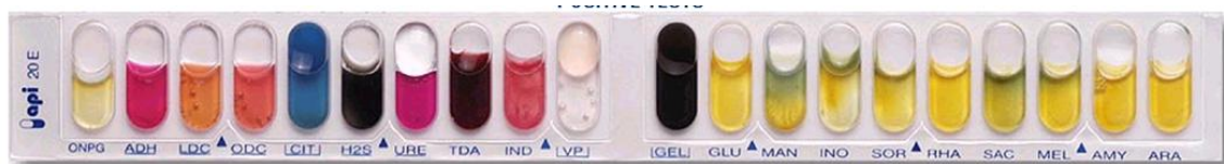
Figura 22. Aspecto de la galería API 20E con resultados positivos (48 h de incubación máxima).
