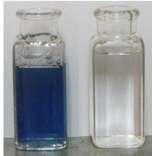
Figura 32. Reacción por la formación de azul de molibdeno, después de dos minutos de reacción.
