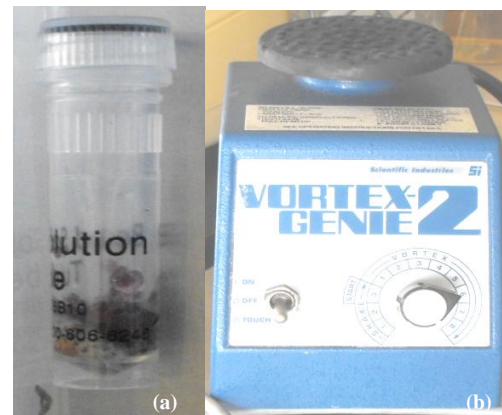
Figura 26. Las perlas en el tubo (a) en combinación con la aplicación de vortex (b), se utiliza para la lisis mecánica de la pared celular y posibles estructuras de resistencia.
