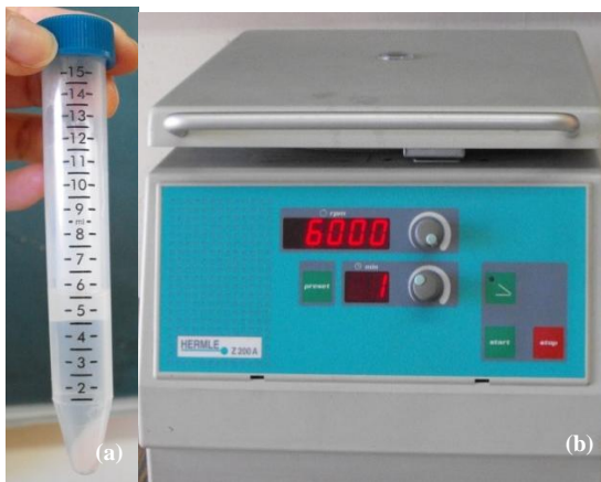
Figura 25. La concentración de la biomasa (a) se realiza por centrifugación (b).
