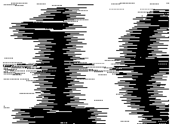
Figura 3.17. Reconstrucción inadecuada de la imagen cuando bWait = F . Los bordes del carácter “16” no se definen.
