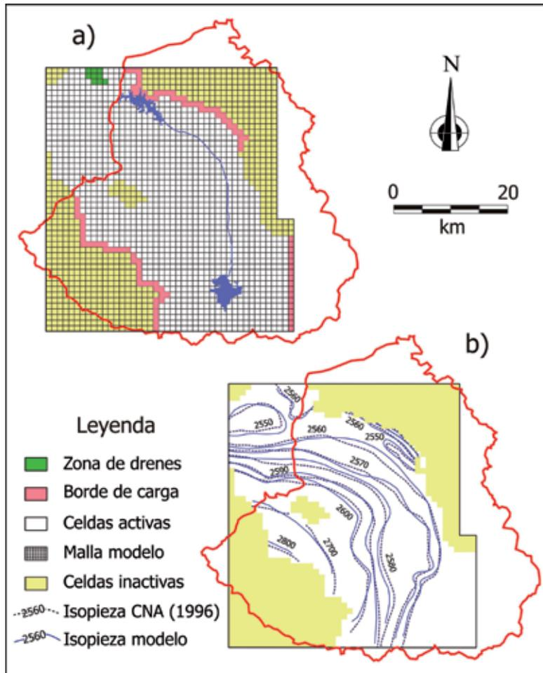
**Figura 5.** (a) Discretización del área de estudio y condiciones de frontera del modelo de flujo de agua subterránea y (b) comparación de niveles estáticos del agua subterránea simulados y observados en la calibración en estado estacionario para el año 1996.
