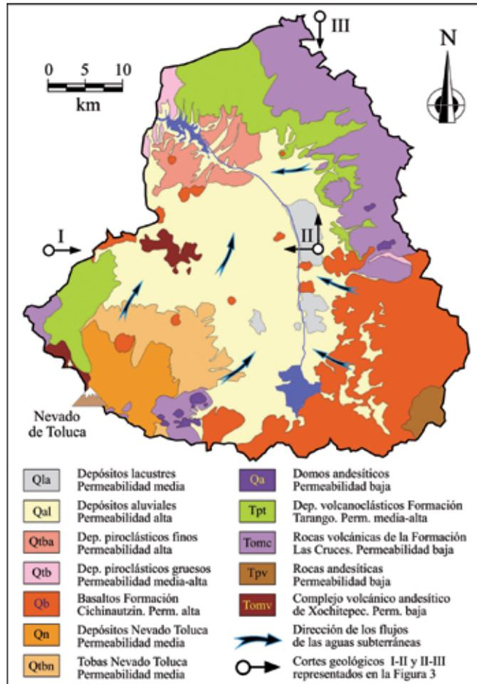
**Figura 2.** Esquema general hidrogeológico del acuífero del valle de Toluca. Las flechas representan la dirección del flujo de agua subterránea.
