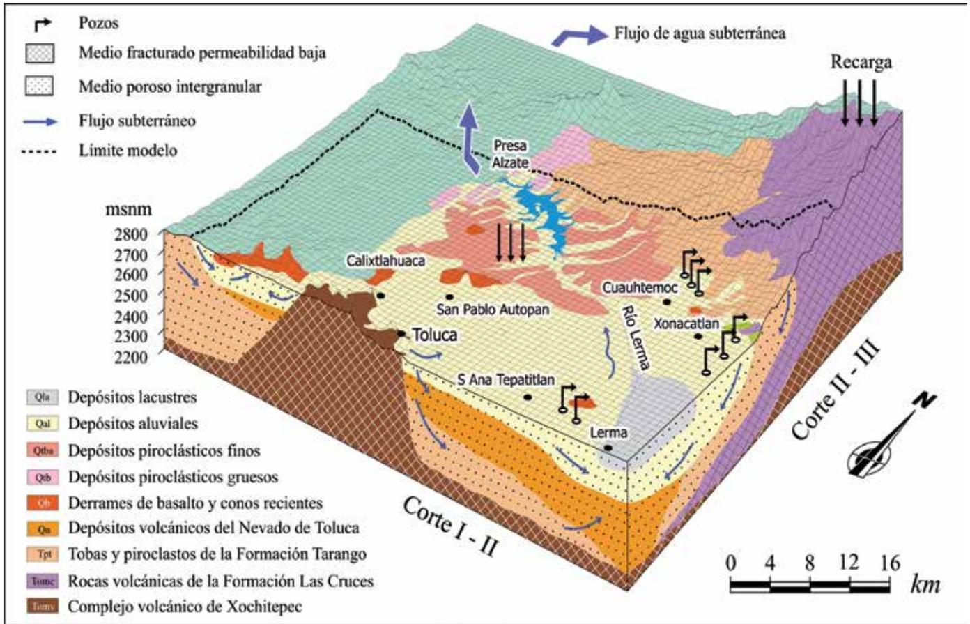
**Figura 3.** Esquema tridimensional del modelo conceptual del acuífero del valle de Toluca y límites del modelo de flujo de agua subterránea.
