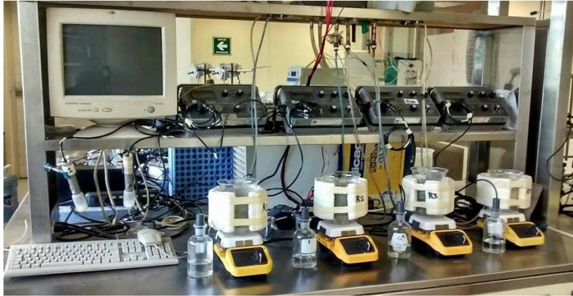
Figura 6.2.1. Respirómetro instalado en el Laboratorio de Calidad del Agua del CIRA.
