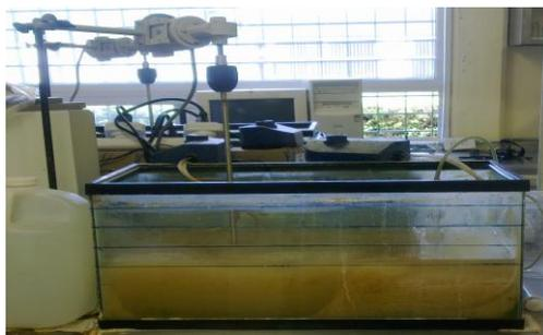
Figura 6.1.1 Imagen del reactor de lodos activados tipo batch de 30L, instalado en el Laboratorio de Calidad del Agua del CIRA.
