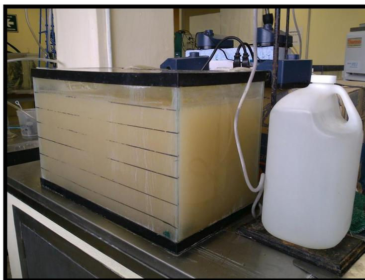
**Figura 5.1** Vista del reactor RBS
