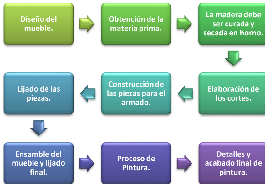
Figura 23. Diagrama del proceso de elaboración del mueble.
