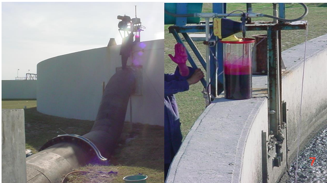
Figura 28. Medición de caudal Q20 mediante prueba de trazador. Inyección en el sedimentador primario.
