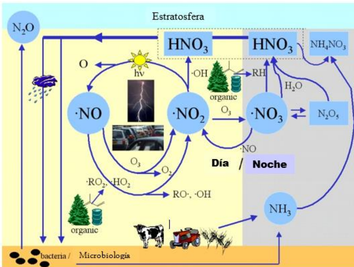
Figura 1.3 Implicación del NO 2 en la formación de contaminantes secundarios perjudiciales, en la atmósfera.
