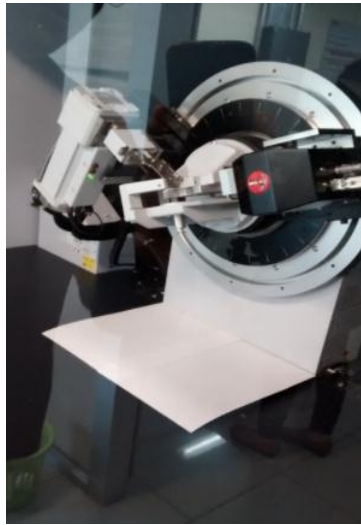
Figura 9. Difractómetro de rayos X de polvos para la caracterización de matriz y refuerzo
