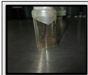
Mezcla de 0.119 gramos de \text{CoFe}_2\text{O}_4 y CaO por agitación magnética por 72 horas.
