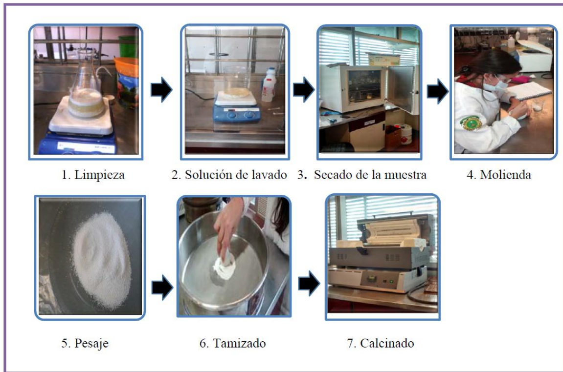
Figura 16. Procedimiento de obtención de CaO a partir de cascarón de huevo
