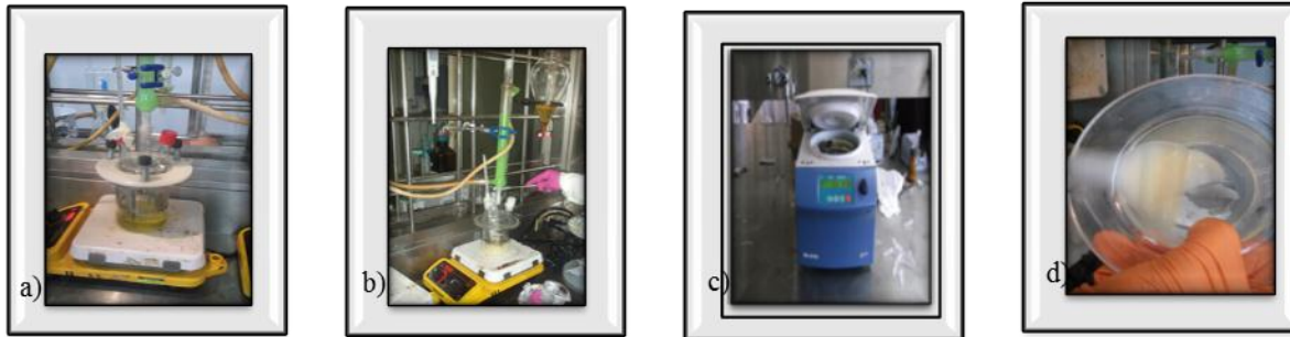
Figura 45. Producción de biodiesel de aceite de reúso con CaO a) calentamiento b) adición del catalizador y metanol c) centrifugación d) separación del CaO
