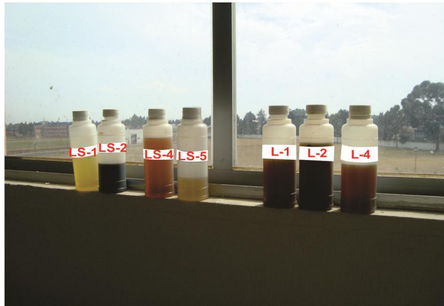
Figura 3.8. Apariencia física de los lixiviados captados con los lisímetros de succión LS-1 a LS-5 y de libre drenado L-1 a L-4. Es posible observar que entre cada muestra de lixiviados no hay semejanza en cuanto a su tonalidad, indicando directamente la heterogeneidad que caracteriza a los RS. Fuente: Elaboración propia.
