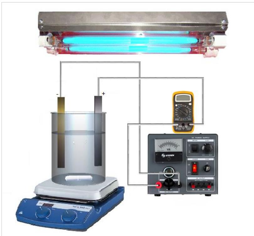
*Figura 8. Celda electrolítica empleada para el proceso de fotoelectrooxidación.*
