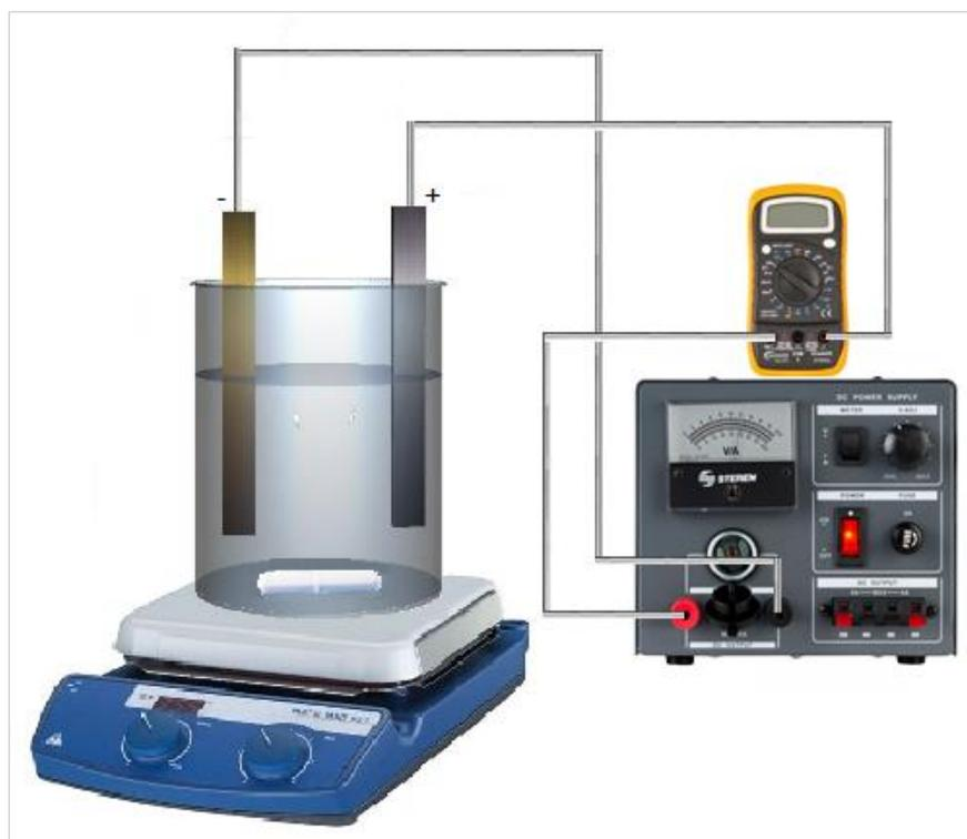
**Figura 7.** Celda electrolítica empleada para el proceso de electrooxidación.
