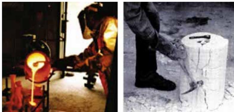
**IMAGEN 22.** El metal fundido se vacía en el molde, el cual posteriormente se rompe para obtener la pieza. Escultor Tuck Langland.
