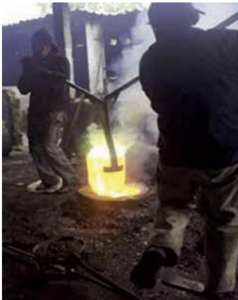
**IMAGEN 7.** Fundidores sacando el crisol del horno. En esta fotografía, el horno de crisol está enterrado para facilitar sacar el crisol con la aleación fundida.
