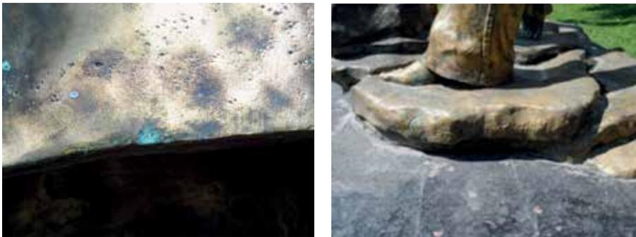
**IMAGEN 9.** En esta otra sección de la escultura, se observan puntos de corrosión, caracterizados por su forma circular, tanto verdosa como oscura y otros puntos de corrosión debido a defectos de manufactura de la pieza. Se observan, además, manchas negruzcas en el pantalón y verdosas en el empeine del pie.
