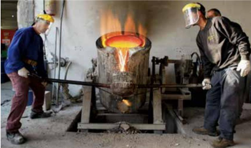
**IMAGEN 6.** Vaciando la aleación fundida desde el horno de crisol a la cuchara de vaciado. Obsérvese el maneral de los vaciadores: un lado es para dirigir y el otro sirve de apoyo para la carga.
