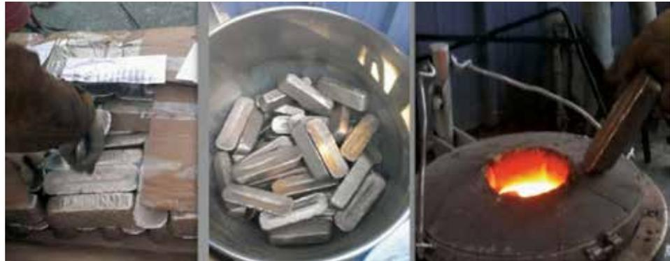
Esto debe ser así, ya que el zinc sublima muy fácilmente y en estado gaseoso produce óxido de zinc muy volátil; el estaño y el plomo forman óxidos color tornasol y normalmente se quedan en la escoria que se va hacia la superficie del baño metálico.
