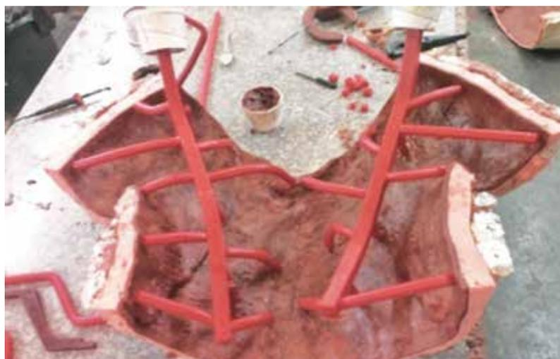
**IMAGEN 28.** Aquí se presenta el sistema hidráulico de alimentación para asegurar que toda la sección de la pieza se llene apropiadamente.
