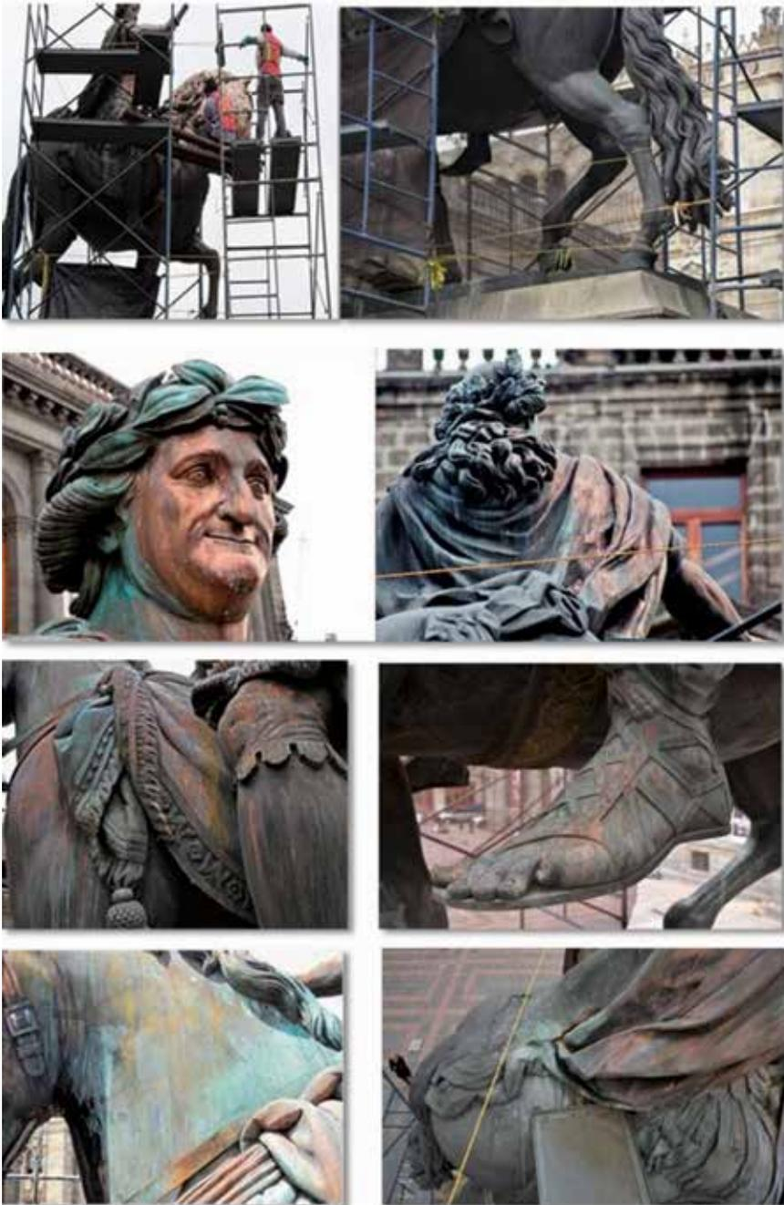
**IMAGEN 5.** Diferentes grados de corrosión creados en la restauración fallida.
