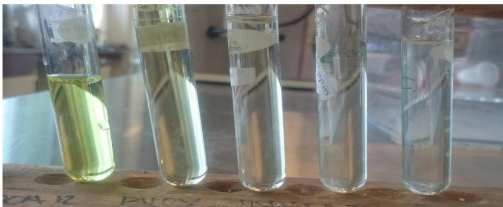
Figura 31 Muestras obtenidas de la reacción de ozonización al agregar 10mg de NPs de Cu.
