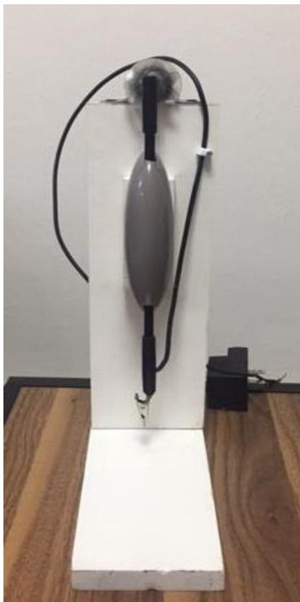
Figura 10 Dispositivo empleado en la síntesis de nanopartículas de Cu por plasma pulsado en líquidos
