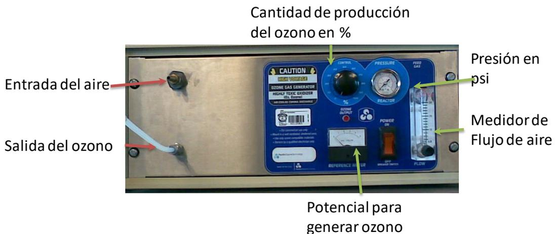
Figura 15 Componentes del generador de ozono Pacific Ozone Technology
