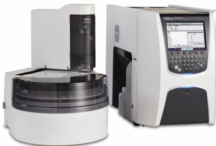
Figura 16 Analizador de Carbono Orgánico Total Shimadzu
