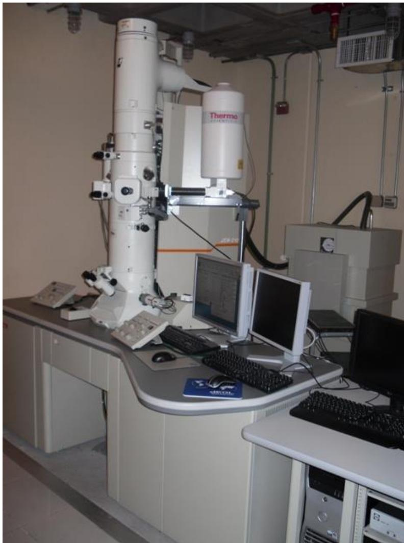
Figura 12 Microscopio electrónico de transmisión JEOL-2100
