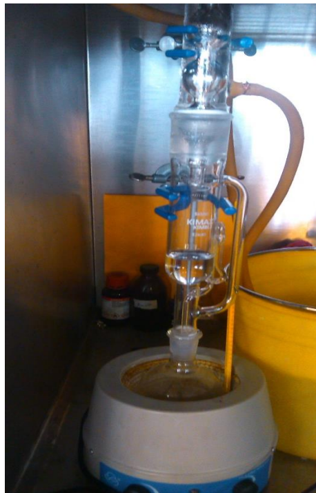
Figura 4 Determinación de extraíbles en el equipo Soxhlet
