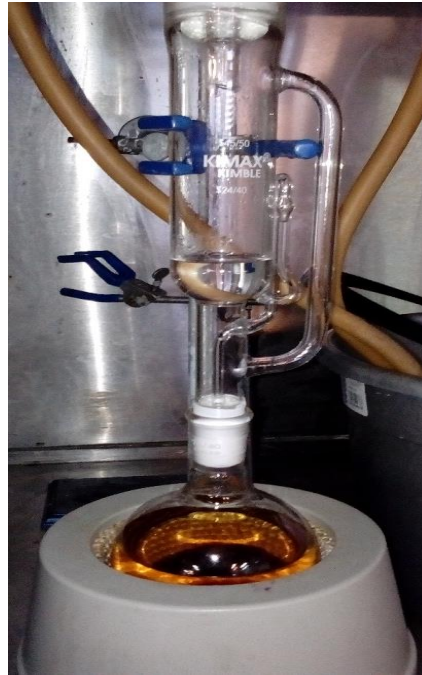
Figura 6 Digestión de ligninas en el equipo Soxhlet
