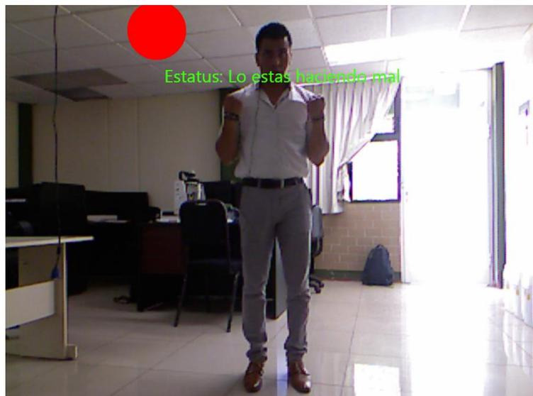
*Figura 5.20. Error de detección de esqueleto por iluminación.*
