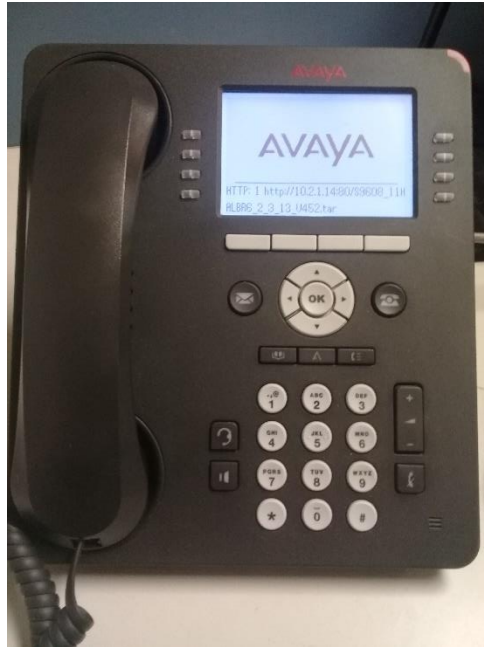
Figura 110. Arranque de teléfono AVAYA.
