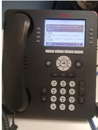
Figura 112. Menú de configuración de teléfono VoIP.
