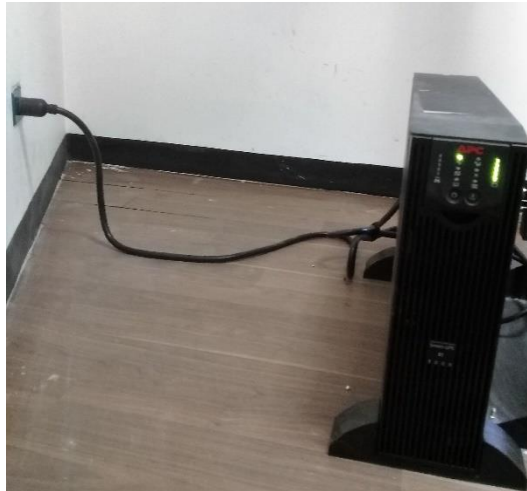
Figura 62. Conexión del UPS al contacto de corriente.
