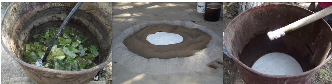
IMAGEN 52. PROCESO Y COMPONENTES DE ELABORACIÓN DEL MORTERO PARA CONSOLIDACIÓN. FOTOGRAFÍA POR ANA LAURA NAVARRO MARTÍNEZ
