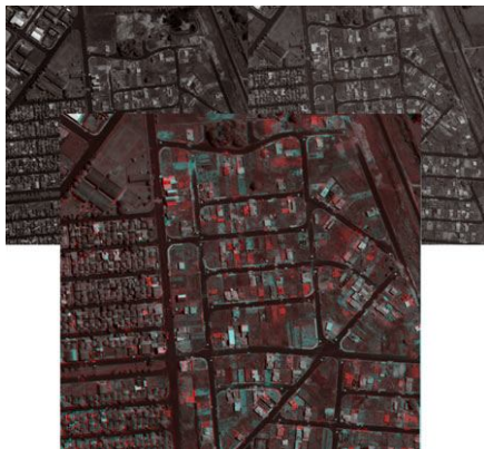
Figura 10.- Identificación de las alteraciones detectadas en el modelo anaglifo Fuente: Barros Guilherme Henrique Departamento de Cartografia. UNESP (2007)
