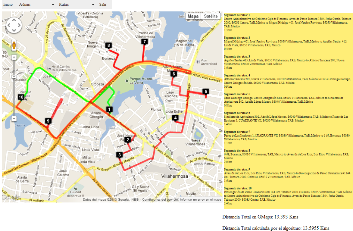
Figura 35. Ruta sugerida obtenida con el método del vecino más cercano en Google Maps
