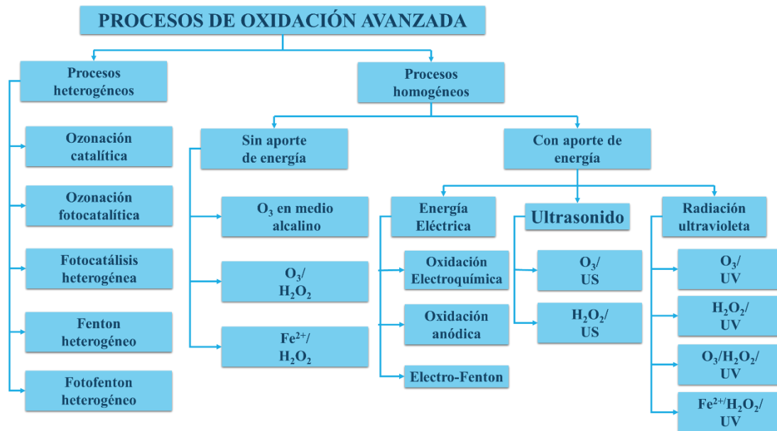
Figura 6. Clasificación de los Procesos de Oxidación Avanzada [65] .
