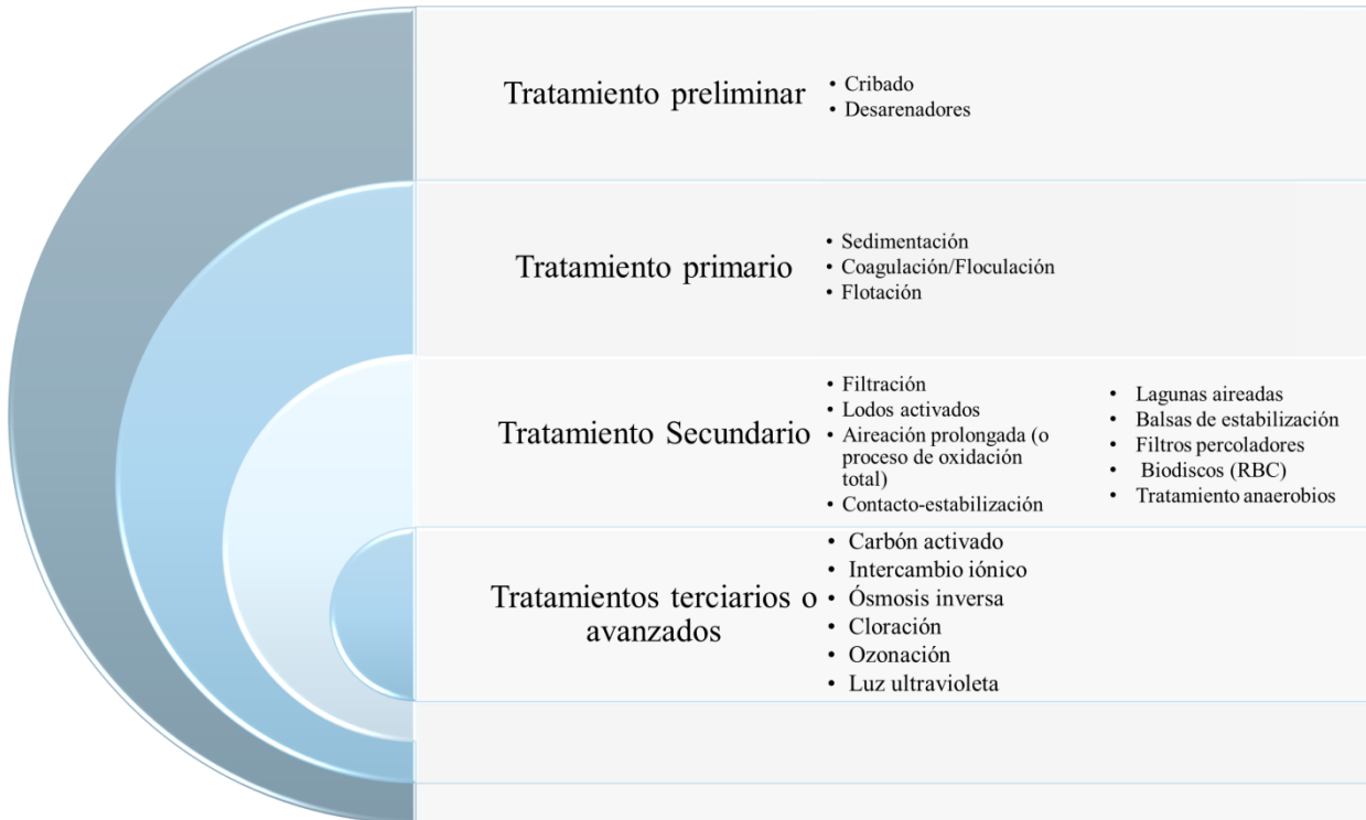
Figura 4. Tren de tratamiento de aguas residuales. Fuente: [49]
