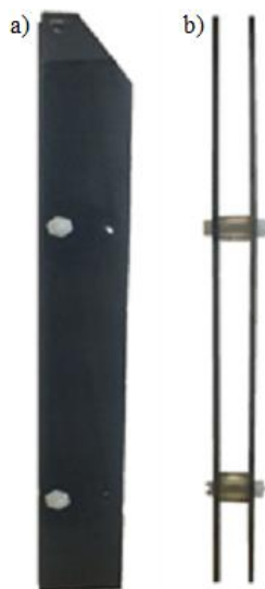
Figura 17. a) Vista de frente y b) vista lateral de los electrodos de Diamante Dopados con Boro.
