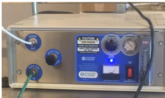
Figura 18. Generador de ozono marca Pacific Ozone Technology.
