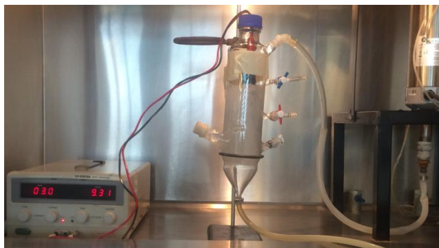
Figura 19. Esquema del proceso acoplado de electrooxidación – ozonación.
