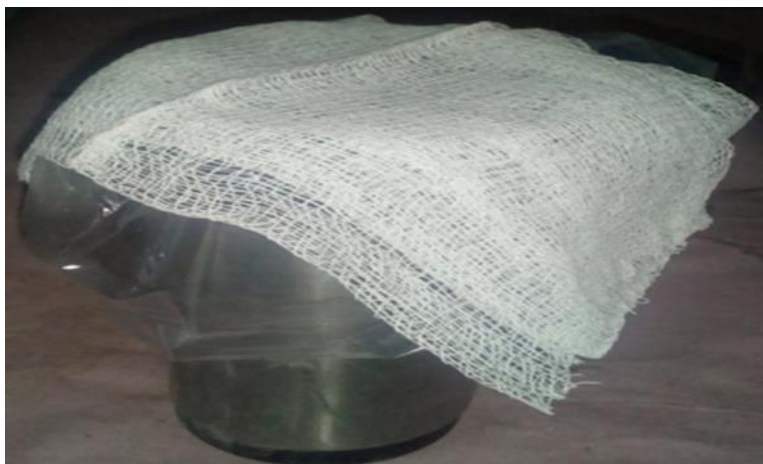
Figura 20. Colocación de la gasa medica en el termo-colector.
