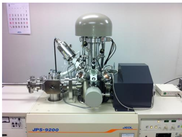
Figura 37. Espectroscopía Foteoeléctrica de Rayos X, JEOL JPS-9200.
