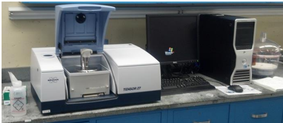
Figura 43. Imagen del FTIR, Tensor 27, Bruker.
