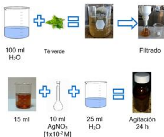
Figura 49. Esquema de la síntesis de obtención de las AgNp-0D por el método de síntesis biológica.
