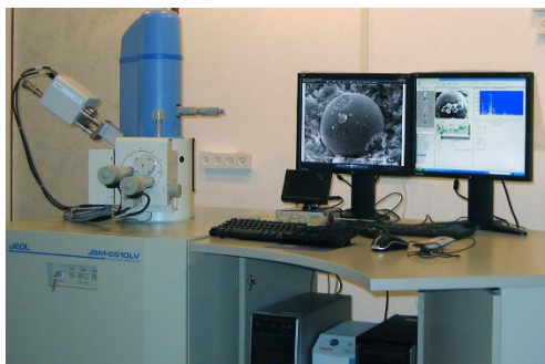
Figura 27. Microscopio electrónico de barrido JEOL JSM-6510LV.
