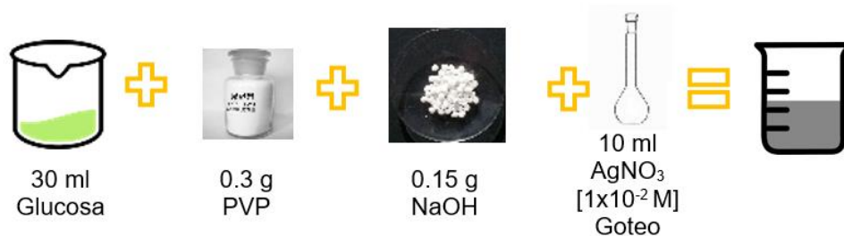
Figura 50. Esquema de la síntesis de obtención de las AgNp-0D por el método de síntesis química con PVP.
