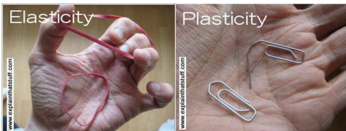
Figura 1. Diferencia entre elasticidad y plasticidad.
