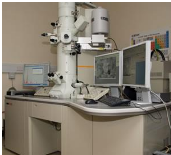
Figura 31. Fotografía del microscopio electrónico de transmisión JEOL-2100 de 200 kV con filamento de LaB 6 .
