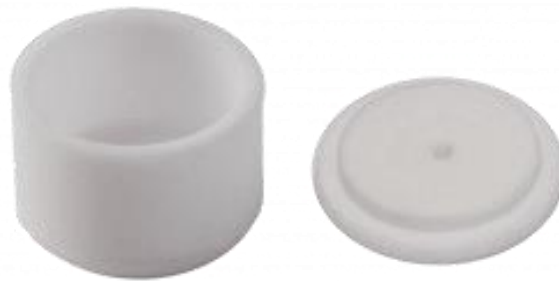
Figura 48. Capsula de alúmina para análisis DSC/TGA.
