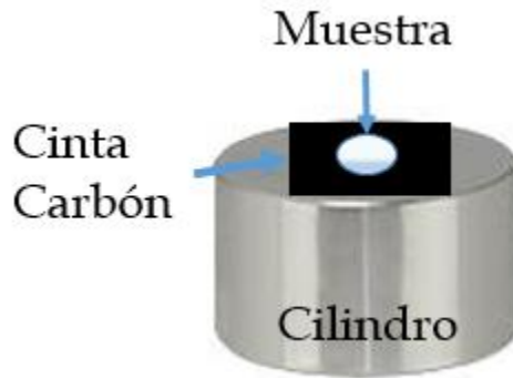
Figura 28. Diagrama para la preparación de la muestra por medio de SEM.
