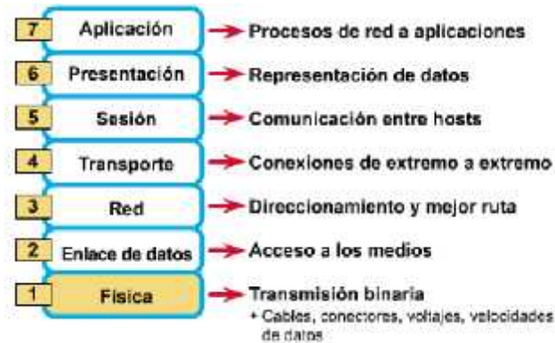
Figura 1 Capas del Modelo OSI “Organización Internacional para la Normalización, 1984”
