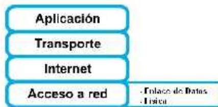
Figura 2 Capas del Modelo TCP/IP “ARPANET, 1972”
