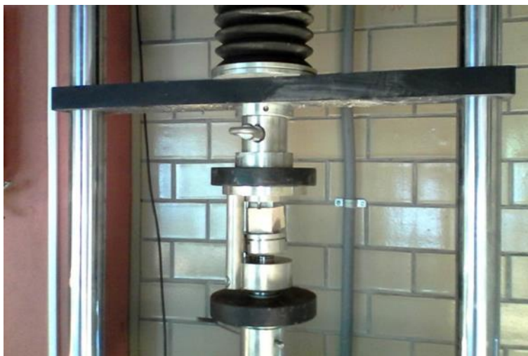
Figura 6.4. Máquina de prueba universal modelo 70-S17C2 (ControlstM, Cernusco, Italia)
