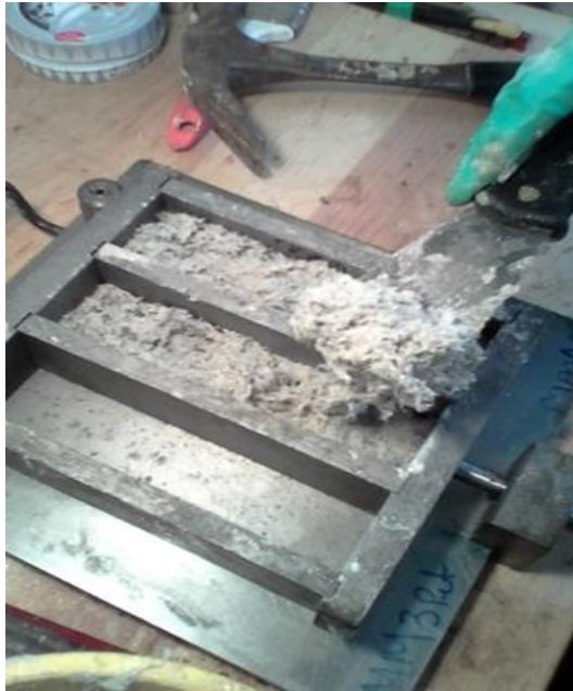
Figura 6.2. Molde para preparación de probetas
