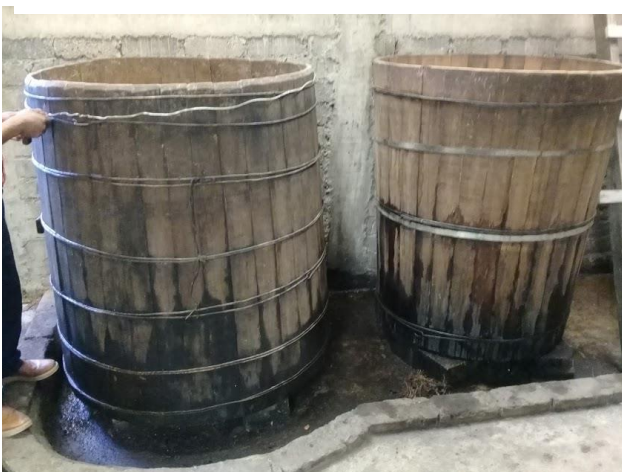
Imagen 3. Tinajas de madera para fermentación Fuente: propia
