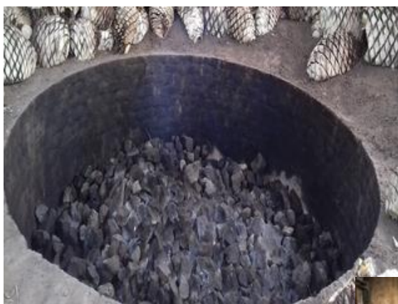
Imagen 5. Horno de mampostería para cocción de agave
