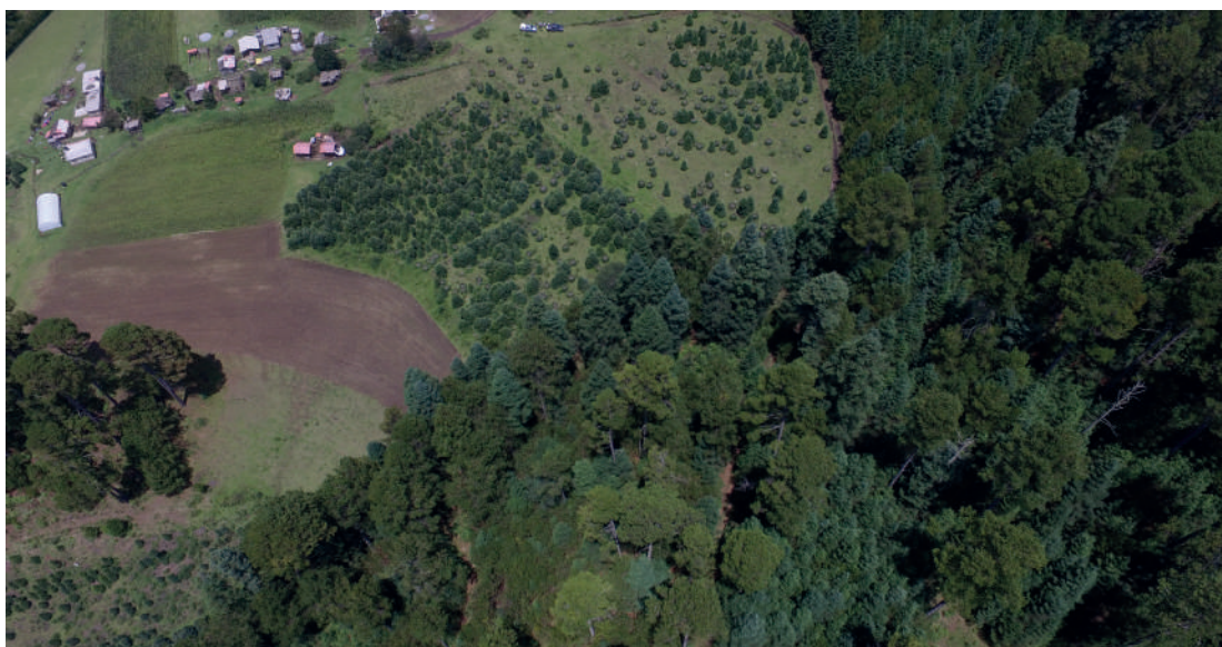
Figura 6. Ejemplo del mosaico rectificado, generado por restitución de imágenes obtenidas por el Dron
