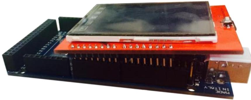
*Ilustración 27. Conexión TFT-LCD con Arduino Mega*
