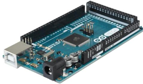
*Ilustración 5. Módulo Arduino mega 2560*
