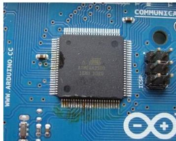
Ilustración 4. Chip Arduino mega 2560. Fuente: <https://oliversmith.io>
