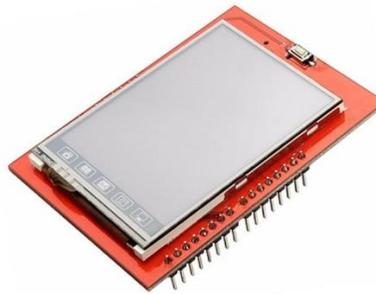
*Ilustración 10. Pantalla TFT LCD Touch 2.4*
