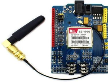
*Ilustración 6. Modulo GSM SIM 900.*
