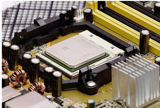
Imagen 1. Procesador AMD Athlon 64 X2 conectado en el zócalo de una placa base.
